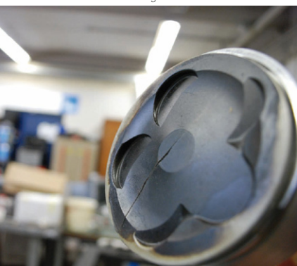
Topview onto cracked piston head. Draufsicht auf einen gerissenen Kolbenboden.
